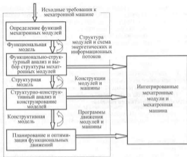
Рис. 2.4. Процедура проектирования интегрированных мехатронных модулей и машин
