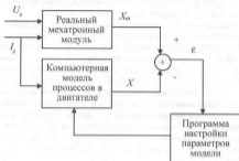
Рис. 2.8 Схема настройки системы "бессенсорного" управления: U_s , I_s – соответственно входные напряжение и ток статора двигателя; X_m , X – выходные переменные соответственно реального двигателя и компьютерной модели; \epsilon – погрешность оценки
