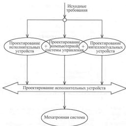
Рис. 2.3. Алгоритм параллельного проектирования мехатронных систем
