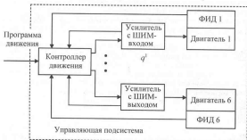
Рис. 2.13. Структура системы управления робота "RUMA-560" на основе контроллера движения
